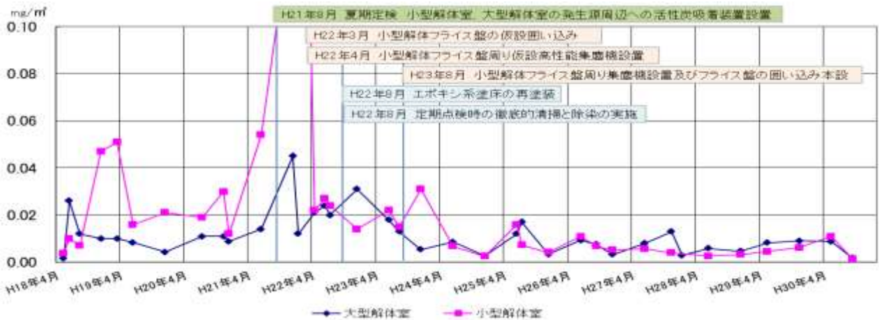
図-2 作業環境中PCB濃度の経時変化及びPCB濃度低減対策実施状況
