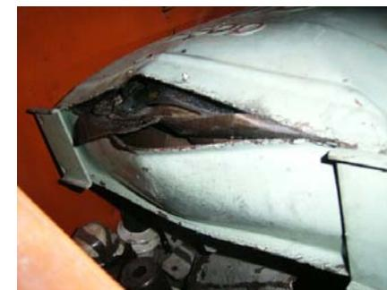
短絡等により破裂・変形や内部素子が炭化したコンデンサ
