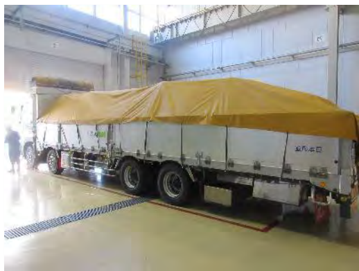
トラックに積み込み覆い施し払い出しを行う
