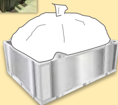
ラッピング材で密封した撤去品は専用トレイに入れたまま払出す
