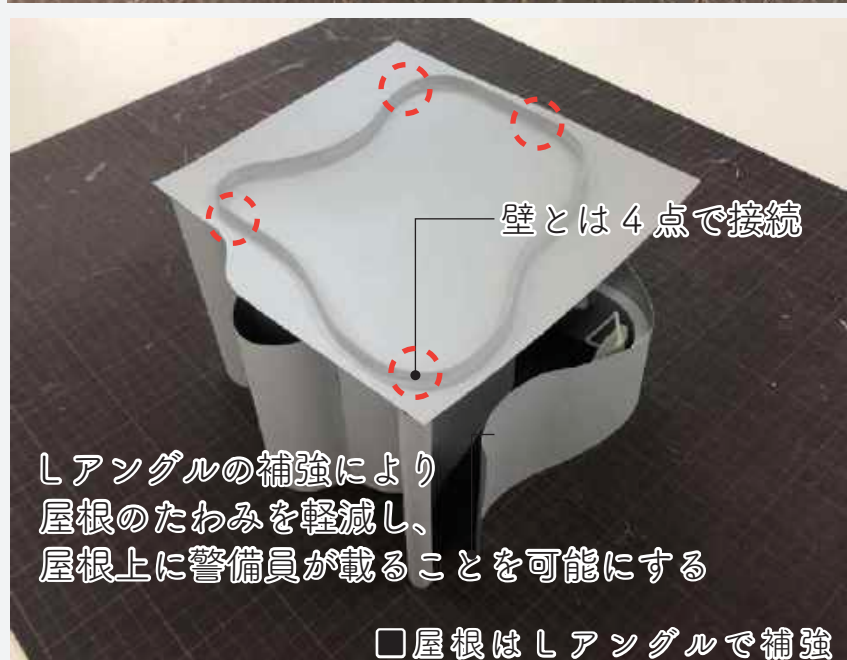
□屋根はLアングルで補強
