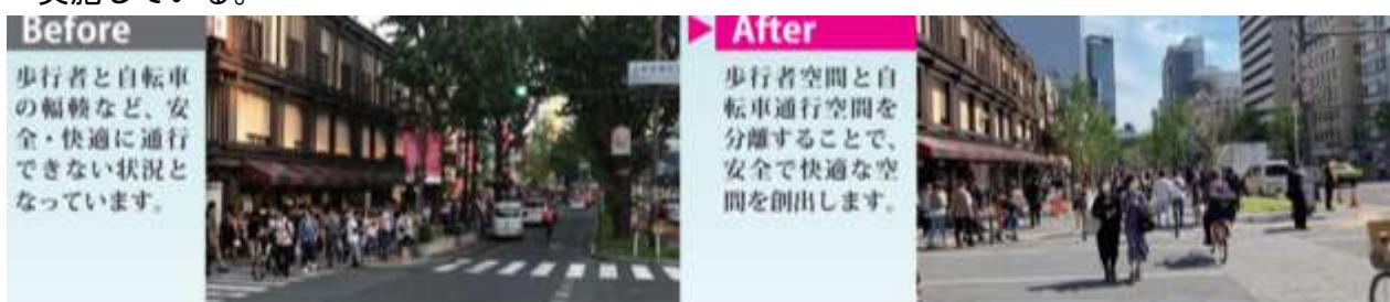
【断面構成】側道閉鎖により、幅 44m のうち 27m が歩行者空間化されることになる。
