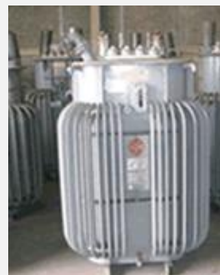
高圧トランス
