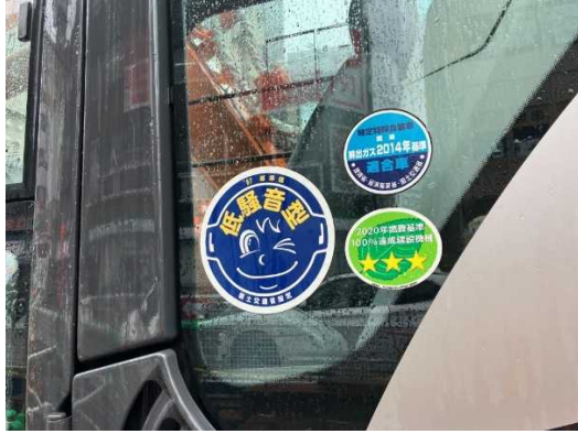
写真 8.1 排出ガス対策型及び低騒音型機械
