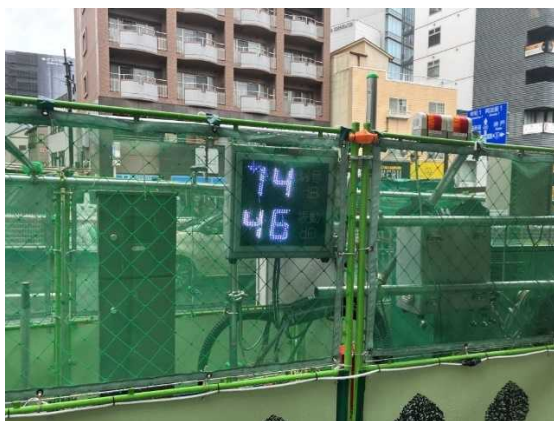
写真 8.9 騒音・振動の計測・表示
