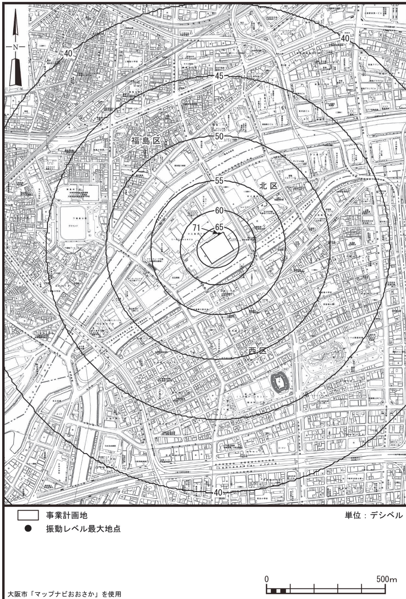
図 5-3-5 建設機械振動予測結果（工事最盛期）
