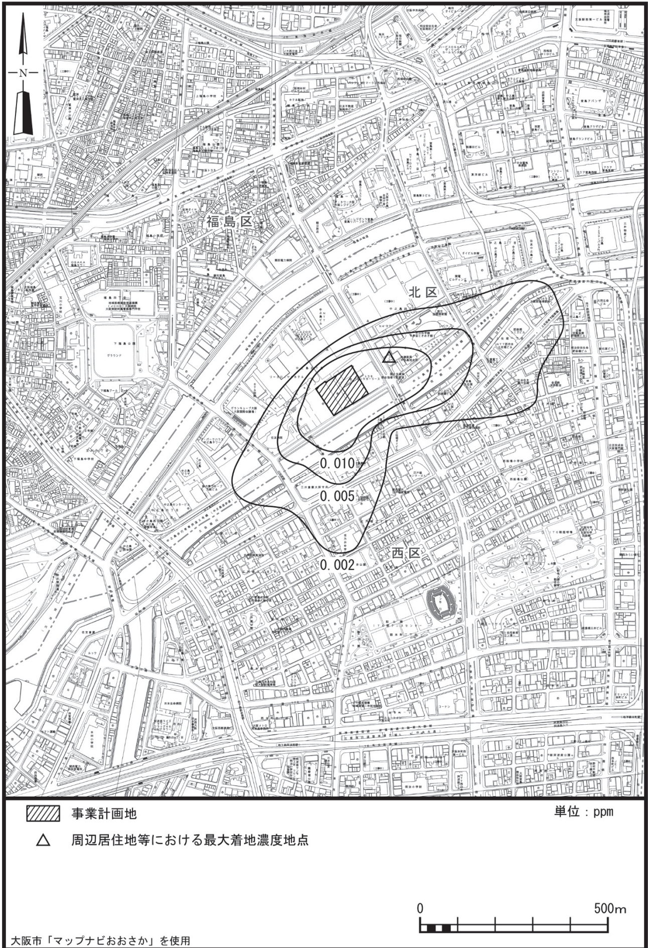
図 5-1-10 建設機械の排出ガスによる窒素酸化物年平均値寄与濃度（工事最盛期）
