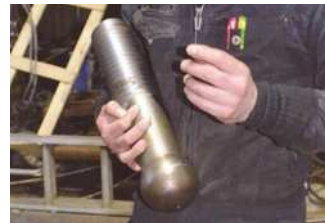
自作の刃物を用いて手作業で加工したノコ歯ネジ部分と端部をCNC旋盤で丸めたシャフト。
