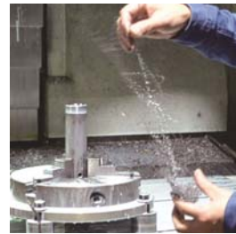
切削加工時に出る切りくずの処理も課題の一つ。
