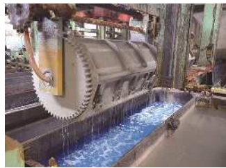
オートメーションでバレルが次々と溶液の中をもぐっていく。
