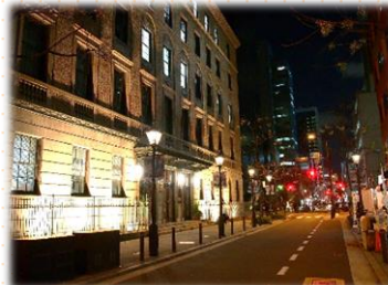
無電柱化された三休橋筋の様子
