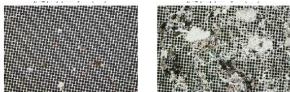
図8 成形板 B 1 (左)及び B 2 (右)の下部のバットに 捕集された模擬雨水をろ過したフィルタの比較
