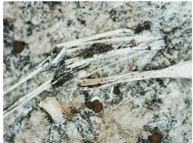
図3 成形板 B 1 (左)及び B 2 (右)の表面の実体顕微鏡像 (成形板 B 2 は石綿繊維が容易に確認できるなど表面の劣化が激しい)
