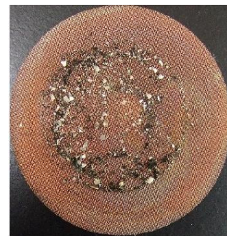
図5 成形板 A 下部のバットに 捕集された水をろ過したフィルタ
