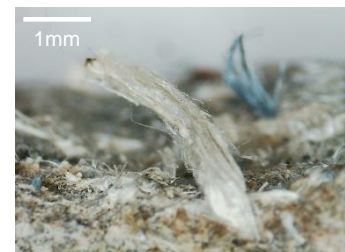
図2 成形板中クリソタイル (石綿は細い繊維が束になっている)
