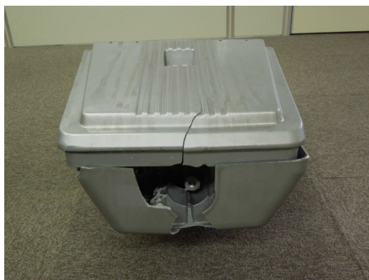
参考写真4-1 地際部における損傷や過度の振動による損傷事例
