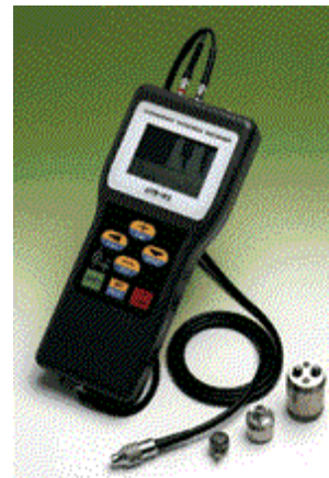
図-1.1 超音波厚さ計の一例
