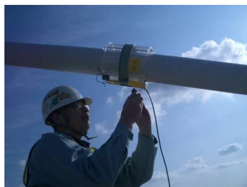
図 4.3 左：渦流探傷調査用機器構成 右：渦流探傷法測定状況
