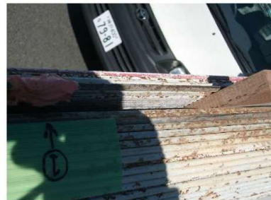
内層素線確認 (上面ｸﾞﾙﾞ割り)
