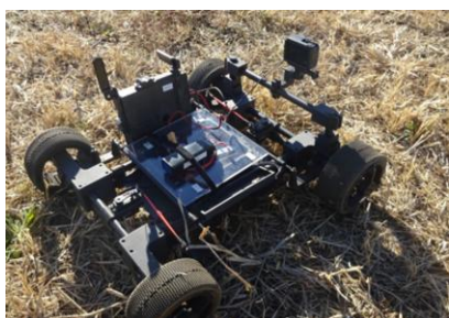
地上走行型ロボットによる 狭隘な桁下空間検査
