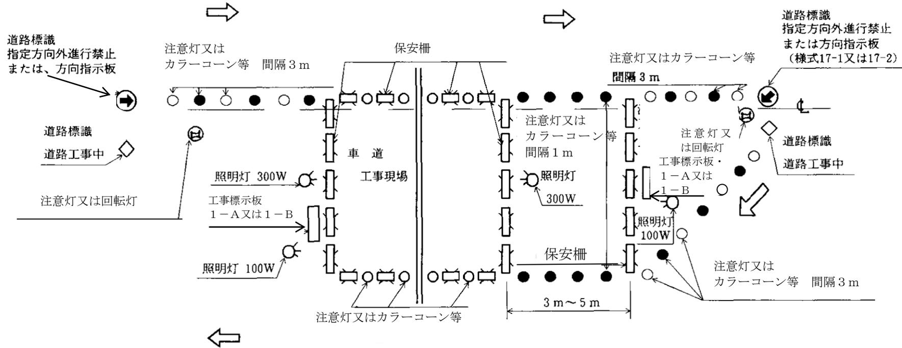
(注)1. 掘削現場と保安柵の距離は、工事作業中に限り車両の出入りに必要な最小限の長さに拡大できる。
