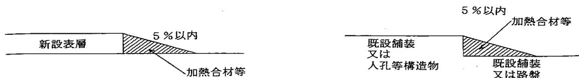
図 I - 1 - 17 段差仮すり付け詳細図
