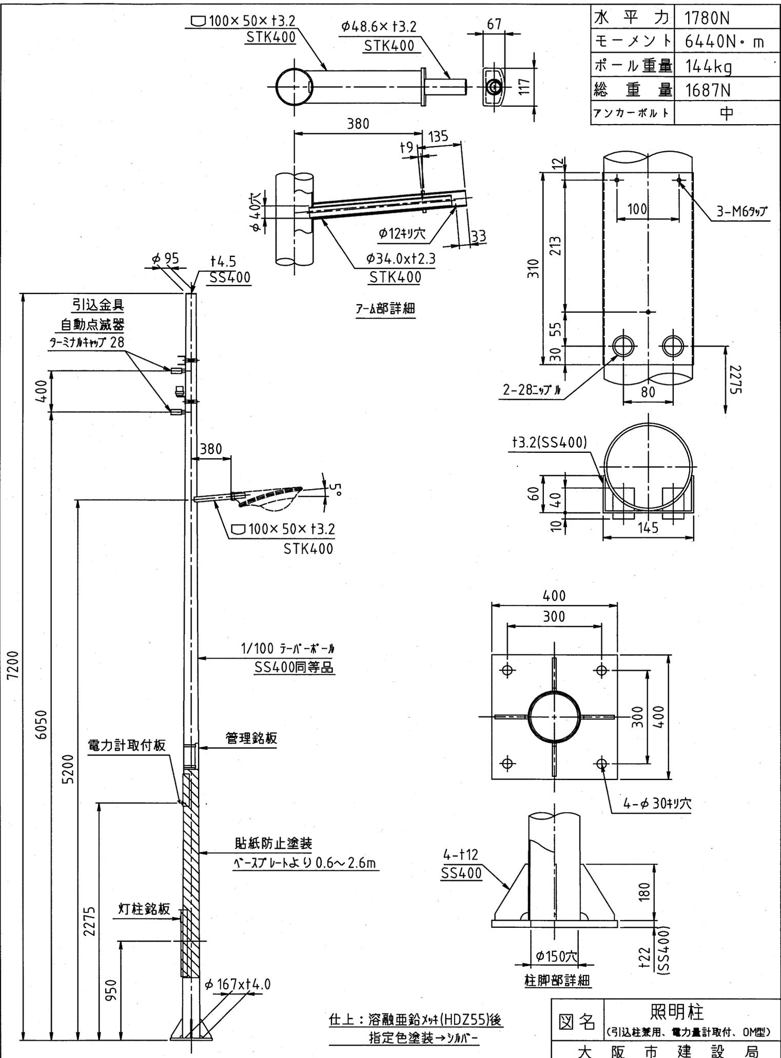
図名 照明柱 (引込柱ポール)
