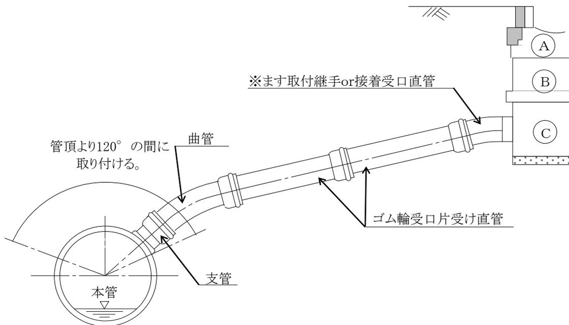
※簡易集水ますに接合する場合は、「接着受口曲管」を使用する。
