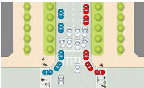
図3-3 緩速車線を閉じた場合（右左折専用レーン無し）
