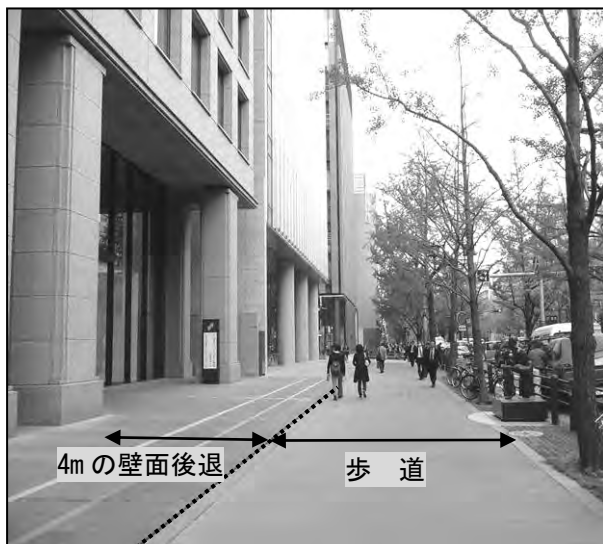
建築物の壁面後退により創出された ゆとりある歩行者空間
