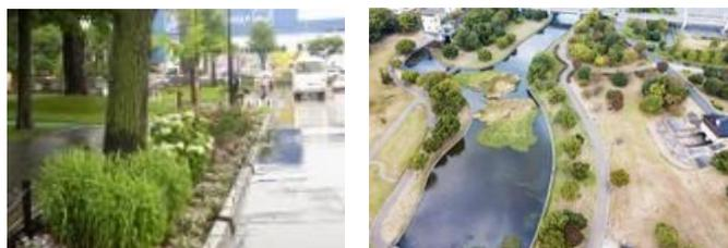
■雨水浸透機能の向上・洪水調節機能の確保（左：札幌市の雨水浸透型花壇、右：深北緑地の遊水地）
