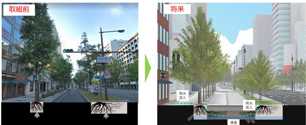
■御堂筋における根系誘導耐震基盤の整備イメージ
