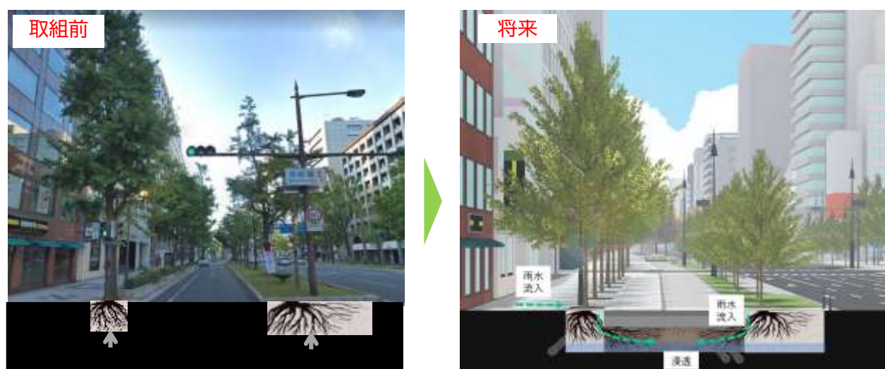
■御堂筋における根系誘導耐圧基盤の整備イメージ
