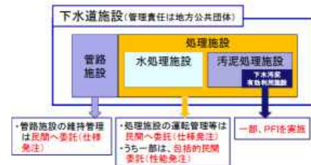
図4 下水道の維持管理に関する委託状況の概念図 (資料：国土交通省資料)
