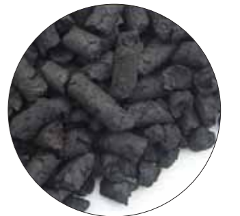
下水汚泥から生成した炭化燃料
