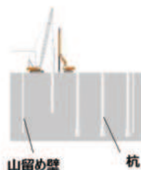
①山留・杭工事
