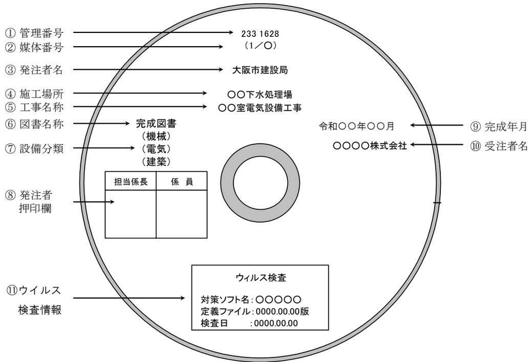
図 2-4 機械・電気、建築機械・建築電気、建築工事 媒体管理情報
