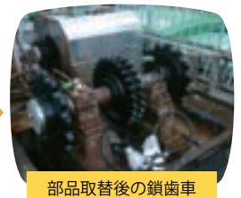
設備の主要部品取替による長寿命化
