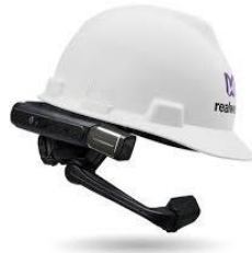
ウェアラブルカメラを活用して現場の状況をリアルタイム共有
