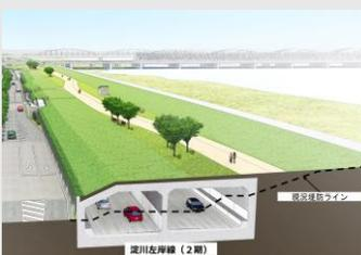
淀川左岸線(2期)区間においては、淀川の堤防内に、河川堤防と道路ボックスを一体構造とした道路トンネルを構築。これは、日本で初めての構造。
