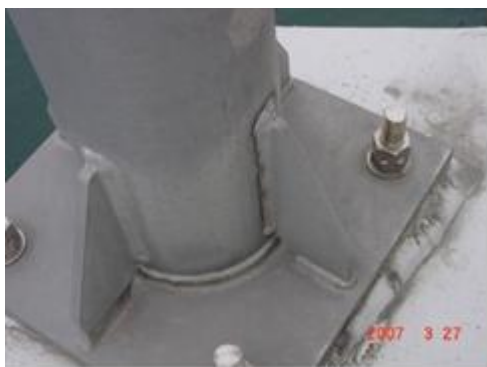
写真-2.1 支柱基部や支柱断面変化部のき裂変状事例
