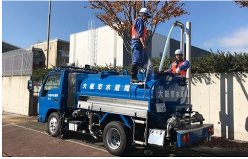
注水設備から応急給水車への注水 (柴島浄水場)
