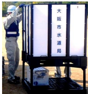
仮設水槽（組立型）
