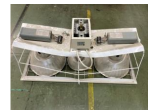
照明器具の落下
