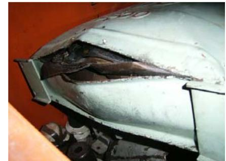
短絡等により破裂・変形や内部素子が炭化したコンデンサ
