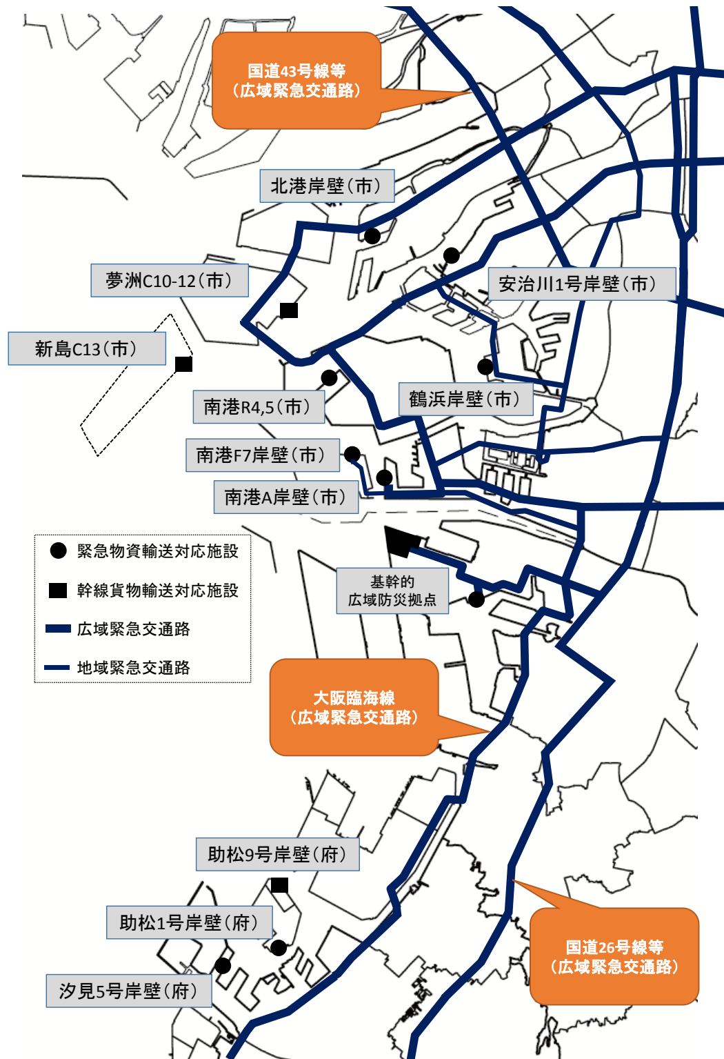
図Ⅶ－２－３ 大阪港及び堺泉北港における耐震岸壁及び緊急交通路の配置
