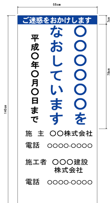
お知らせ看板B(施工中)
