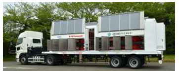
高圧水素トレーラー
