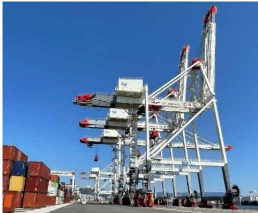
インバータ制御方式のガントリークレーン
