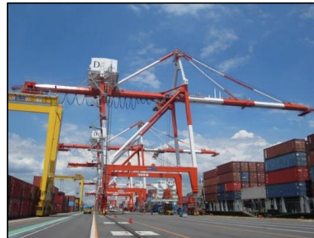
インバーター制御方式による ガントリークレーン
