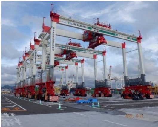
電動トランスファークレーン
