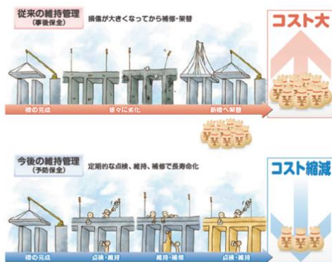
【予防保全（状態監視型）の維持管理】
