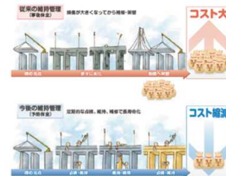
予防保全(状態監視型)の維持管理
