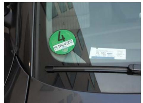
排ガス規制をクリアしているステッカー
