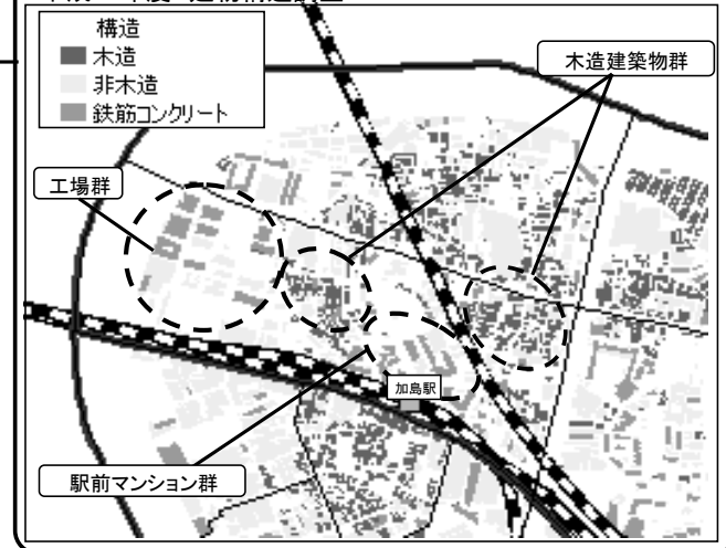
平成19年度 建物構造調査
