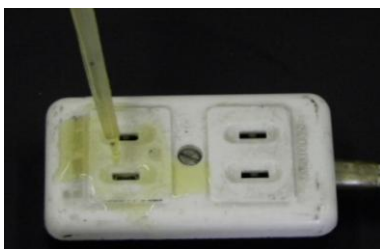
通電中のテーブルタップに尿をかけます。
