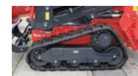
走破性に優れた油圧式ゴムクローラー
