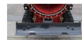
走行ルートを確保できる、重機の排土板のような障害物除去装置
